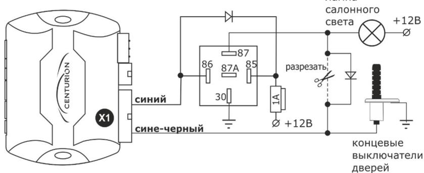
2. F7-2 «Импульс 30 сек. при каждом включении режима охраны».
