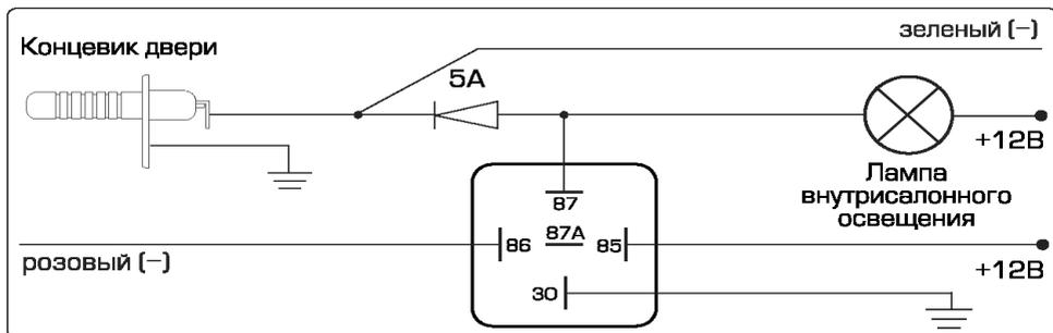
Схема подключения внутри салонного освещения с положительной полярностью
