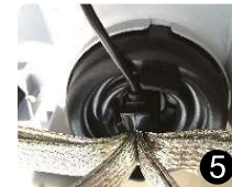
5 Установите Лампу. Максимально расправьте радиатор
