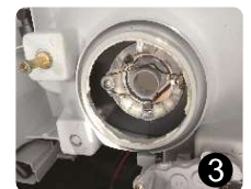
3 Установите базу в фару. Зафиксируйте штатным креплением.
