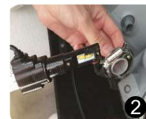
2 Снимите базу с лампы. (Для ламп H4 и H7)
