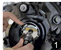
1 Отключите питание. Извлеките галогенную лампу из фары.
