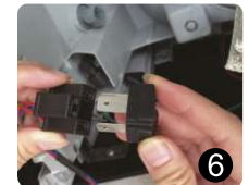
6 Подключите к штатной проводке автомобиля
